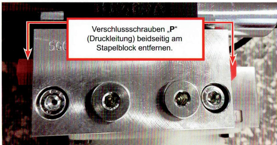
**7.6.2** Hydraulikschläuche mit Druckleitung „P“ (G3/8“ Innengewinde) am Stapelblock verschrauben.
