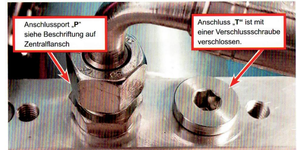
„T“ kann als separate Leckölleitung genutzt werden. Sollte lediglich die Leitung „P“ benutzt werden, so bleibt die Anschlussmöglichkeit (T) mit der dafür vorgesehenen Verschlusschraube verschlossen. (Detailzeichnungen finden Sie auf Seite 22 und 23) Bitte achten Sie darauf, dass die verwendeten Anschlussstücke dabei gem. den jeweiligen Anzugsdrehmomenten angezogen sind. (Hierbei auf Herstellerangaben achten)
