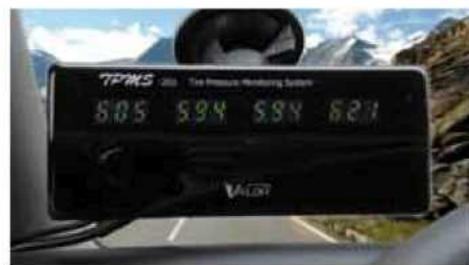
wachung lassen sich Abweichungen vom optimalen Luftdruck schnell ermitteln. Die Sensoren des VALOR Truck TPMS messen die Druck- und Temperaturwerte im Reifen. Eine Beschädigung oder Diebstahl der Sensoren wird somit ausgeschlossen. Dank der einzigartigen Technik mit ID-Steckmodulen wird auch bei einem Wechsel der Reifenposition immer der Reifen auf der jeweils richtigen Position im Display angezeigt.
